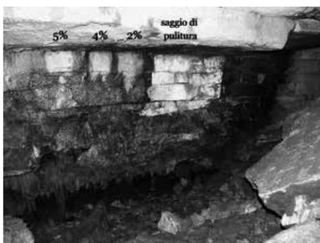
Fig. 4 – Uno dei siti sui quali è stata eseguita l'attività di sperimentazione, con presenza di muschi su un substrato costituito da roccia calcarea ricoperta da latte di monte. Il sito è illuminato da lampade a vapori di mercurio: risultati dei test con ipoclorito di sodio (concentrazioni come indicato in figura) e saggio di pulitura
