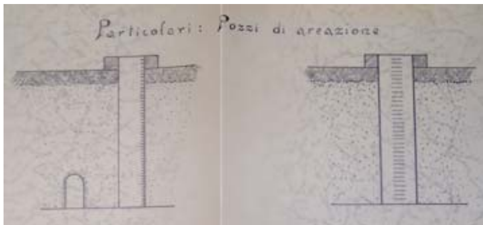
Fig. 10 – Particolari progettuali: pozzi di areazione.
